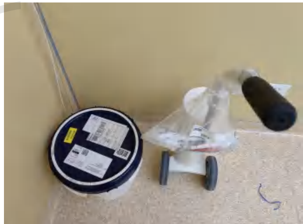
配备了应急储源铅罐、推车、长柄夹子等应急用品
