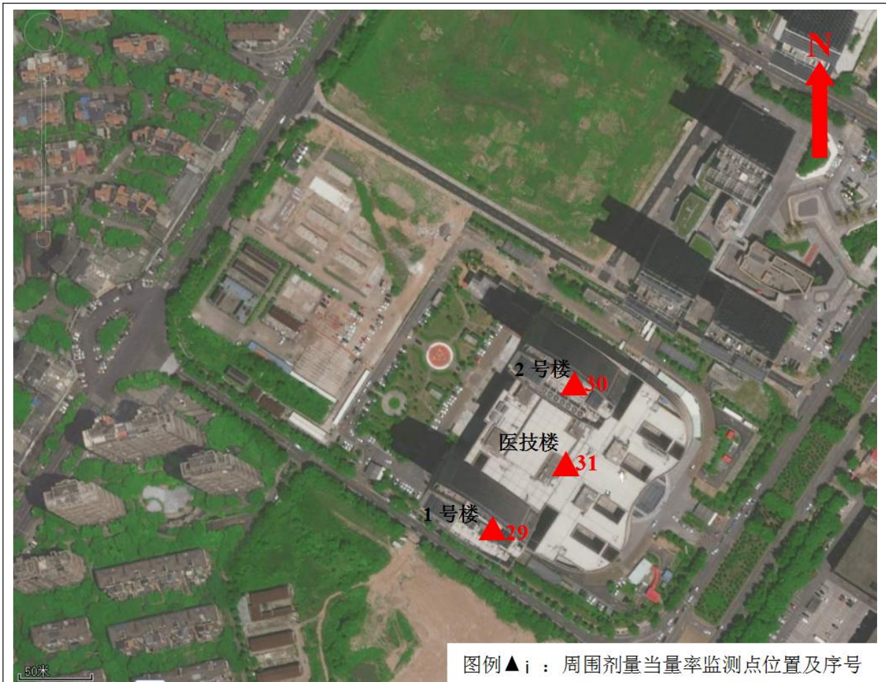
图 6-2 江西省人民医院红谷分院医技楼四楼 DSA 检查室 8 工作场所 50m 范围监测布点示意图
